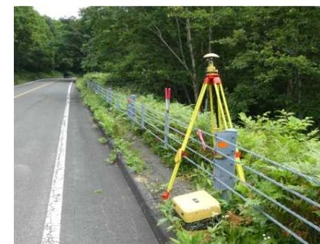
GNSS測量 (準天頂衛星対応機)
