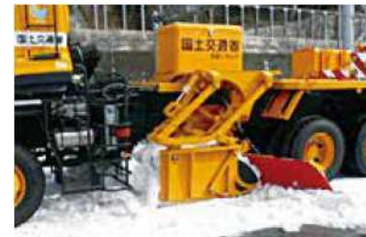
サイドシャッター開閉のマシンコントロール化
