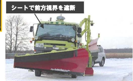
▲車線走行支援ガイダンスによる走行実験状況
