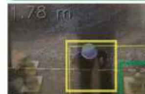
画像に写るものを「人」と「物」に分けて認識し、モニターにそれぞれ色分けした囲み線で表示します。
