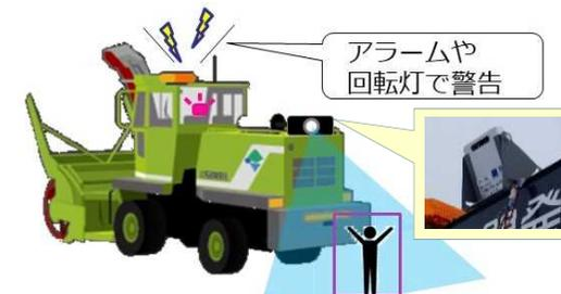
3DカメラとAI物体認証機能を有した接触防止システム
