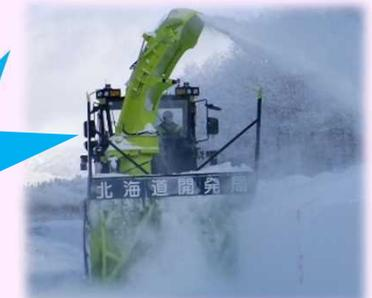
シュート投雪は、投雪方向を案内する装置。投雪角度や方向を調整し、より正確に投雪位置を調整できる。
