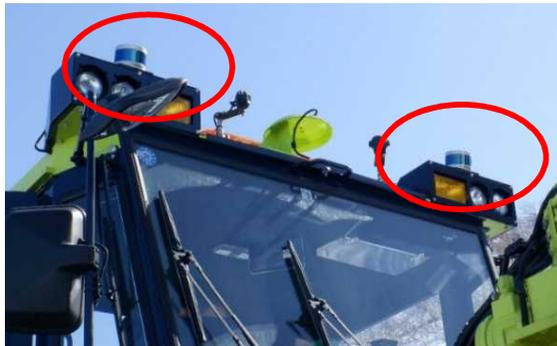
シュート投雪の自動化に必要な不可欠な雪堤高さ検知試験用の3D-LiDAR(左右2基)設置
