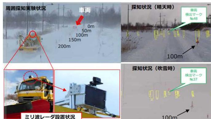
ミリ波レーダによるガイダンスシステムの試験
