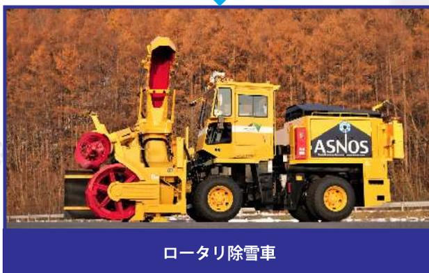
運転支援システムによる除雪車の正確な位置情報と除雪車の作動制御装置を連動することで、除雪車の自律走行※2並びに作業操作を自動化する計画です。今般、北海道支社のテストフィールドで自律走行を確認しました。今後、雪道での自律走行や作業操作の自動化の試験を進め、ロータリ除雪車の自動化の完成を目指しています。
