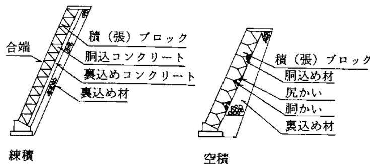
図5-5 コンクリートブロック工
