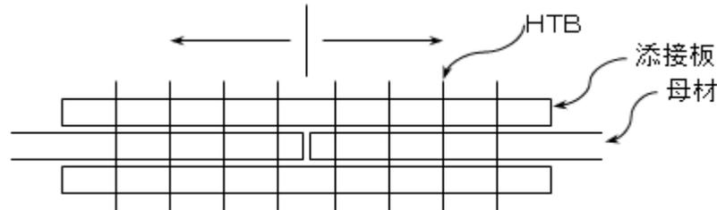
図5-1 ボルト締付け順序
