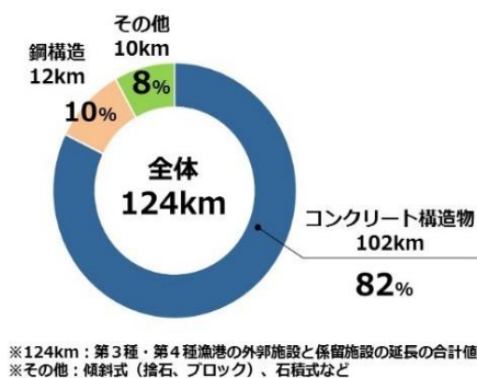
図-5 直轄漁港施設のうち外郭・係留施設の構造特性の割合
