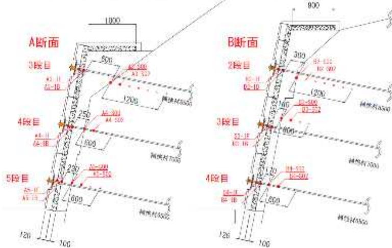
図1 計測位置の断面図
