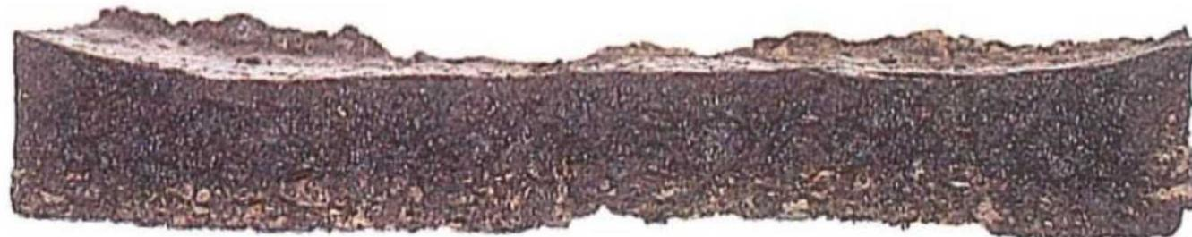
ストレートアスファルト混合物 剥離率50%
