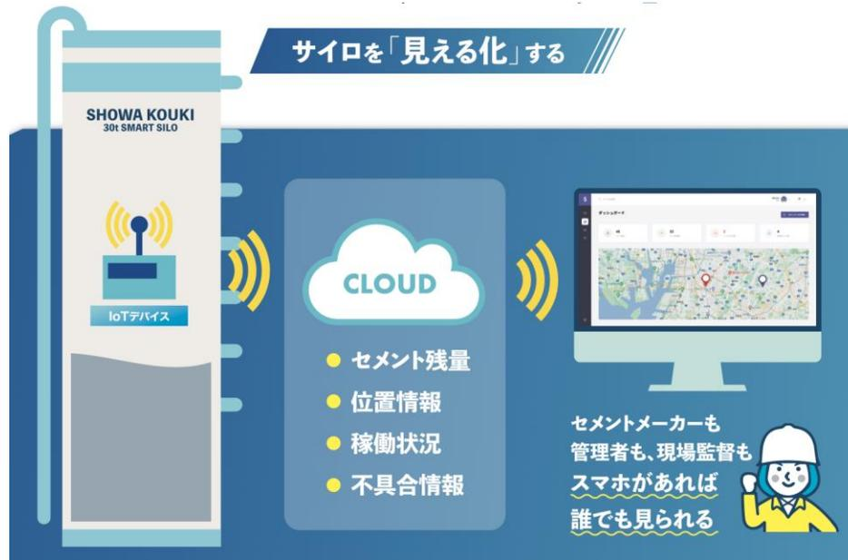
1. 既存サイロにIoTデバイスを設置することにより、レベル計の信号をデータとしてクラウド上に転送。
