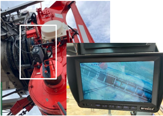
AIクレーンカメラ装着状況 (白枠：クレーンカメラ)
