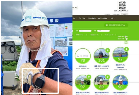
クラウドによる作業者の体調管理 (左：デバイス装着 右：クラウド画面)
