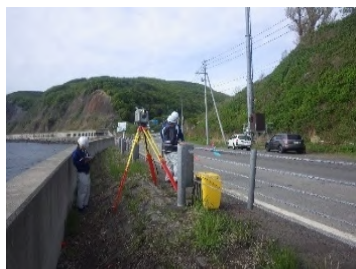
測量状況 (3Dレーザースキャナ)
