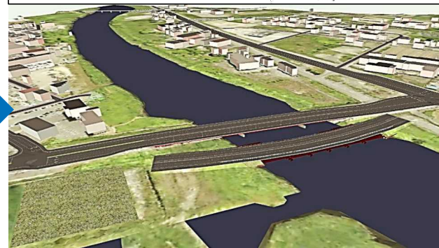
本線道路工、本線供用 仮道・仮橋撤去
