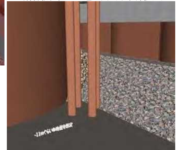
鋼管杭位置での透過図（干渉部拡大）
