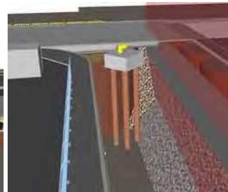
鋼管杭位置での透過図
