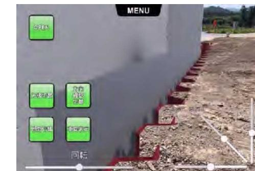
現地の基準点で位置合わせを行い施工箇所にARを重畠することにより、仮設鋼矢板の設置形態や工事完成イメージを現場作業員間で共有
