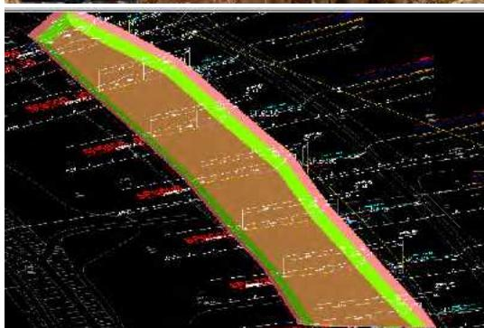
TS測量機・GPS測量機による起工測量
