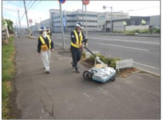
ハンディ型地中レーダーによる地下埋設物探査
