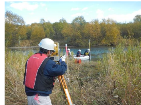
深浅測量（船を使った測量）
