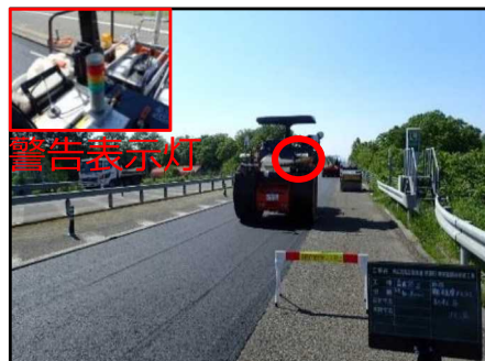
作業者近接検知システム（重機側）
