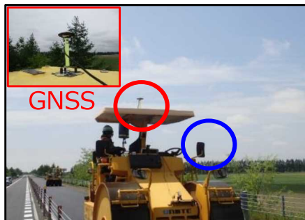
GNSS搭載マカダムローラー
