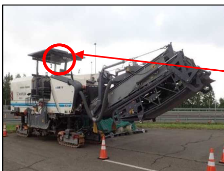
集塵装置搭載型路面切削機
