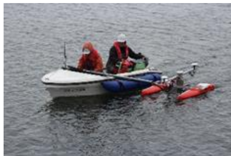
マルチビームによる水中部の測量
