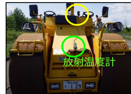
放射温度計搭載マカダムローラー
