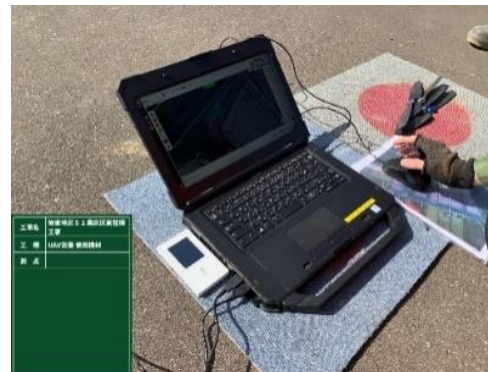
自律飛行の経路・高度プログラム、 撮影状況の確認
