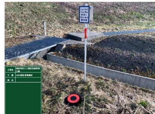
GNSS搭載の対空標識により 自動的に座標、高さを取得
