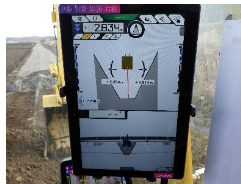
重機運転席のガイダンス画面 (掘削断面・バケット位置の確認)
