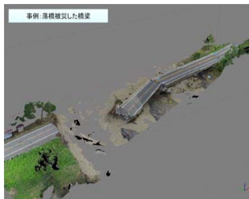
事例:道路崩壊箇所点群モデル
