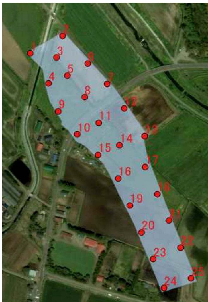
対空標識の設置箇所
