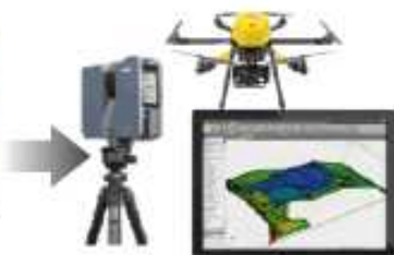
レーザースキャナ、UAV等により面的に測量
