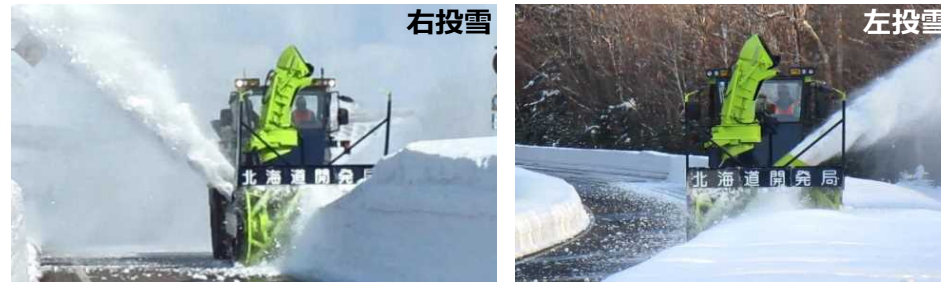
ブロー装置の投雪自動化（右・左）
