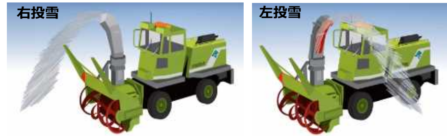
シュート装置の投雪自動化（右・左・前）
