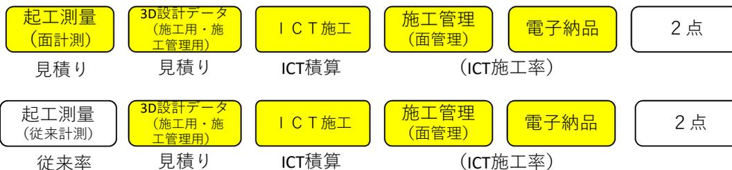
前工事の3次元納品データが活用できる場合等においては、管理断面及び変化点の計測による測量を選択できるものとする
