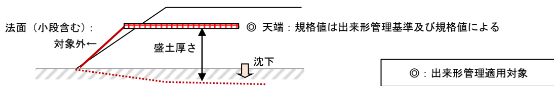
図 5-8 軟弱地盤上における盛土の出来形管理
