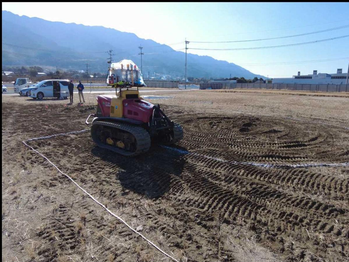
エリア逸脱による緊急停止(2.0km/h)
