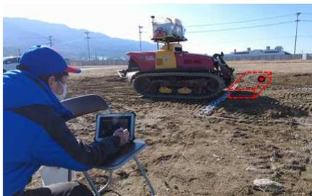
非常停止ボタンを押してから停止するまで(時速2.0km/h・時速4.0km/h)
