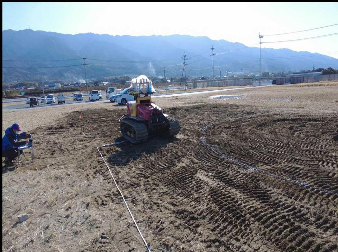
エリア逸脱による緊急停止(4.0km/h)
