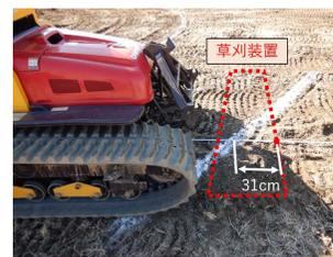
緊急停止距離(時速2.0km/h)
