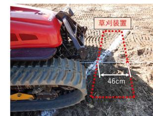
緊急停止距離(時速4.0km/h)
