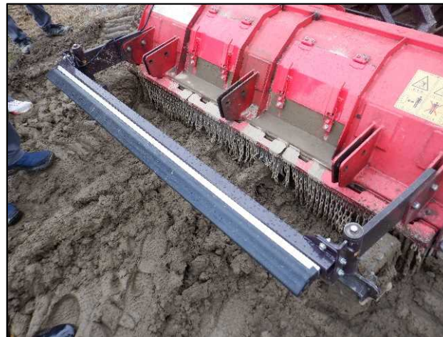
接触自動停止機能(バンパーセンサー)
