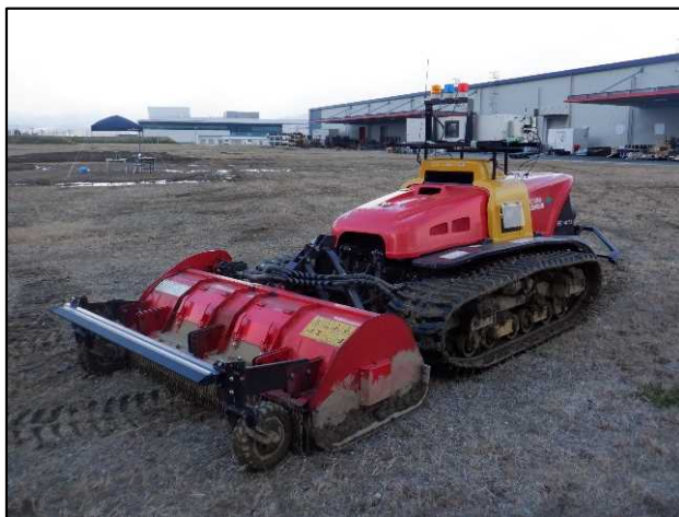
2号機 自動化技術搭載状況
