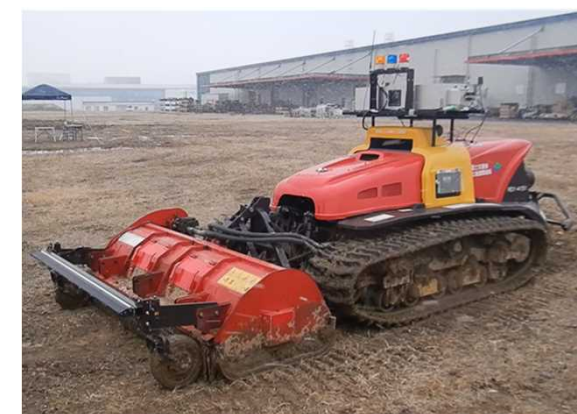
2号機の自動制御システム搭載
