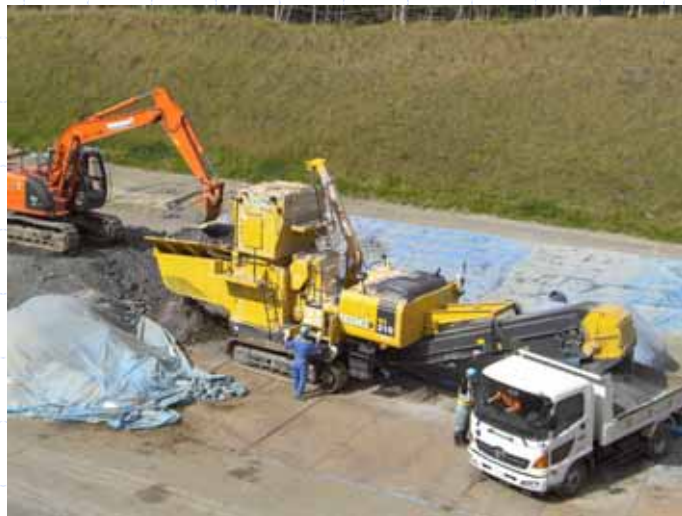
自走式土質改良機混合 40 \text{ m}^3 / \text{h}
