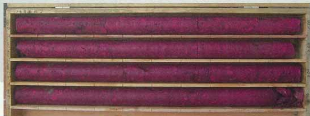
フェノールフタレイン散布後
