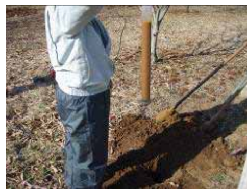
ベラーによる掘削孔からの採水
