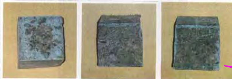
プレキャストパネルの耐久性評価試験
