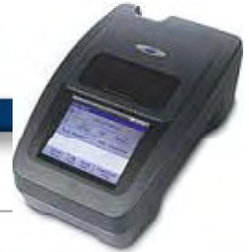
**原理:** 化学反応により目的成分を発色させ光の吸収量から濃度を測定する。
