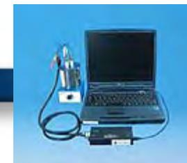
**原理:** 試料溶出液に電位をかけて重金属等を電極上に析出させ、あわせて濃縮させる。その後、電位を解放する時に発生する電流を測定する。
