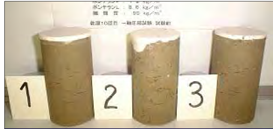
ボンテラン改良土2 (10サイクル終了時 W_0=105\% 固化材 90\text{kg}/\text{m}^3 )
