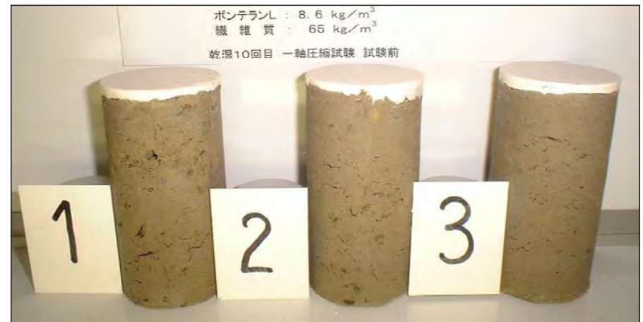
ボンテラン改良土4 (10サイクル終了時 W_0=150\% 固化材 100\text{kg}/\text{m}^3 )
