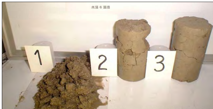
固化処理土2 (6サイクル終了時 W_0=150\% 固化材 100\text{kg}/\text{m}^3 )
