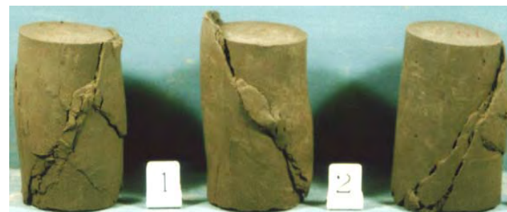
<固化処理土> 明確な破壊面が存在
