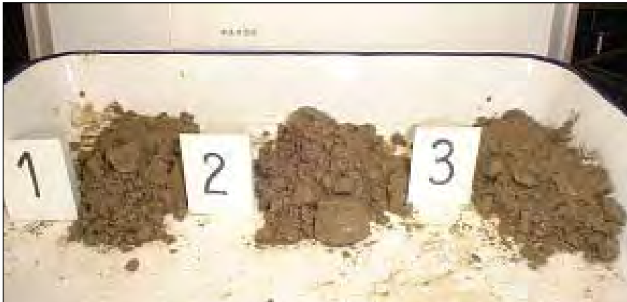
固化処理土1 (2サイクル終了時 W_0=105\% 固化材 90\text{kg}/\text{m}^3 )
