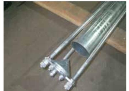
■コンクリート打設装置の先端部(開弁)
