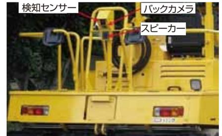
■緊急ブレーキ装置搭載状況
