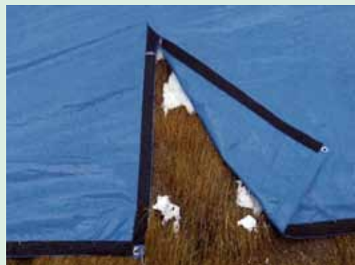
■マジックテープによる接合部
