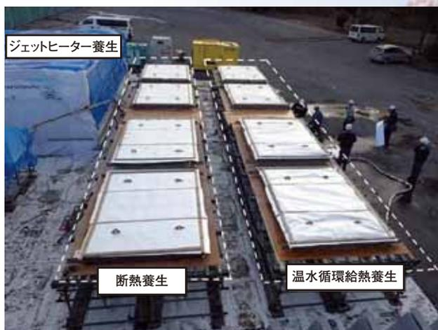
■温水循環給熱養生工法 実験状況
