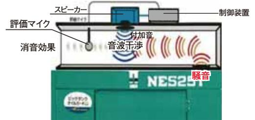
■機材を装着した発電機外観とANCシステム図
