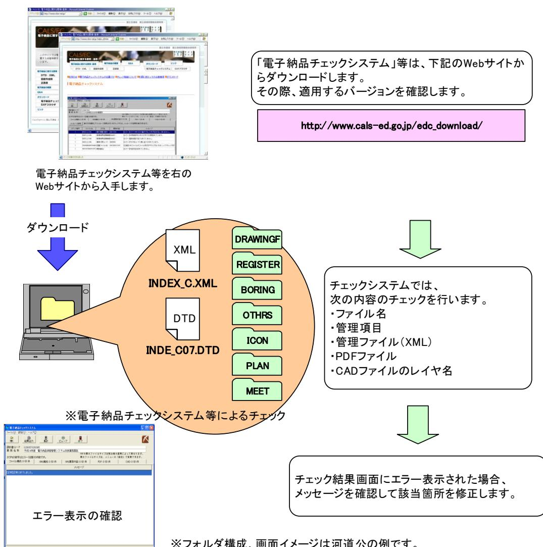
図 10-2 電子納品チェックシステム等を用いた電子成果品のチェック
