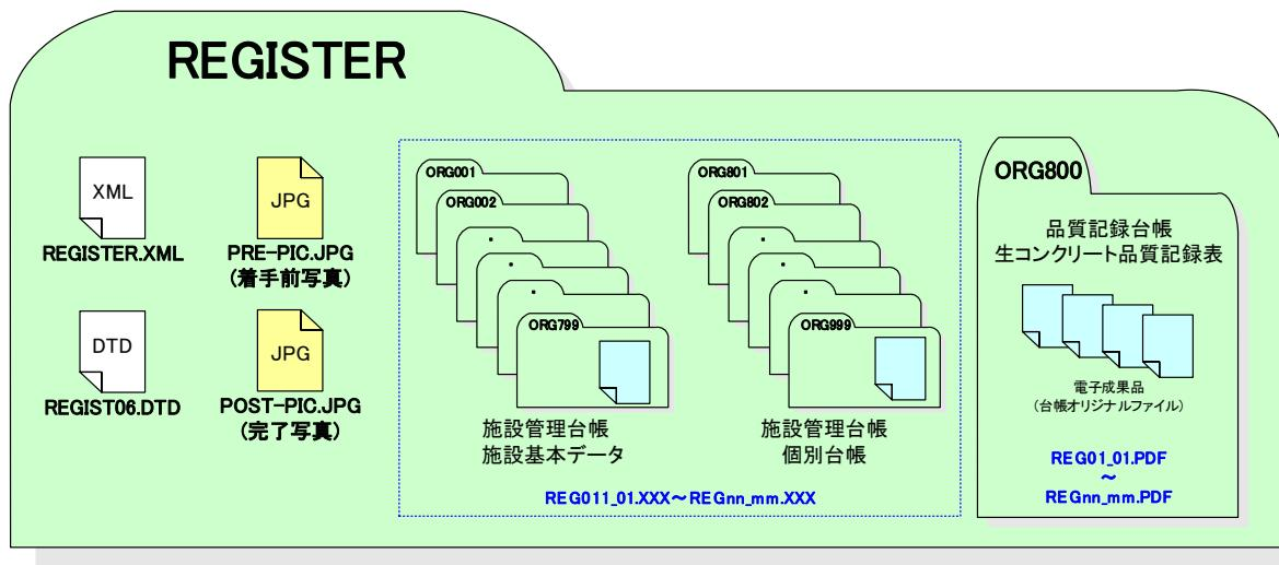
図 7-4 台帳フォルダ（REGISTER）の格納イメージ
