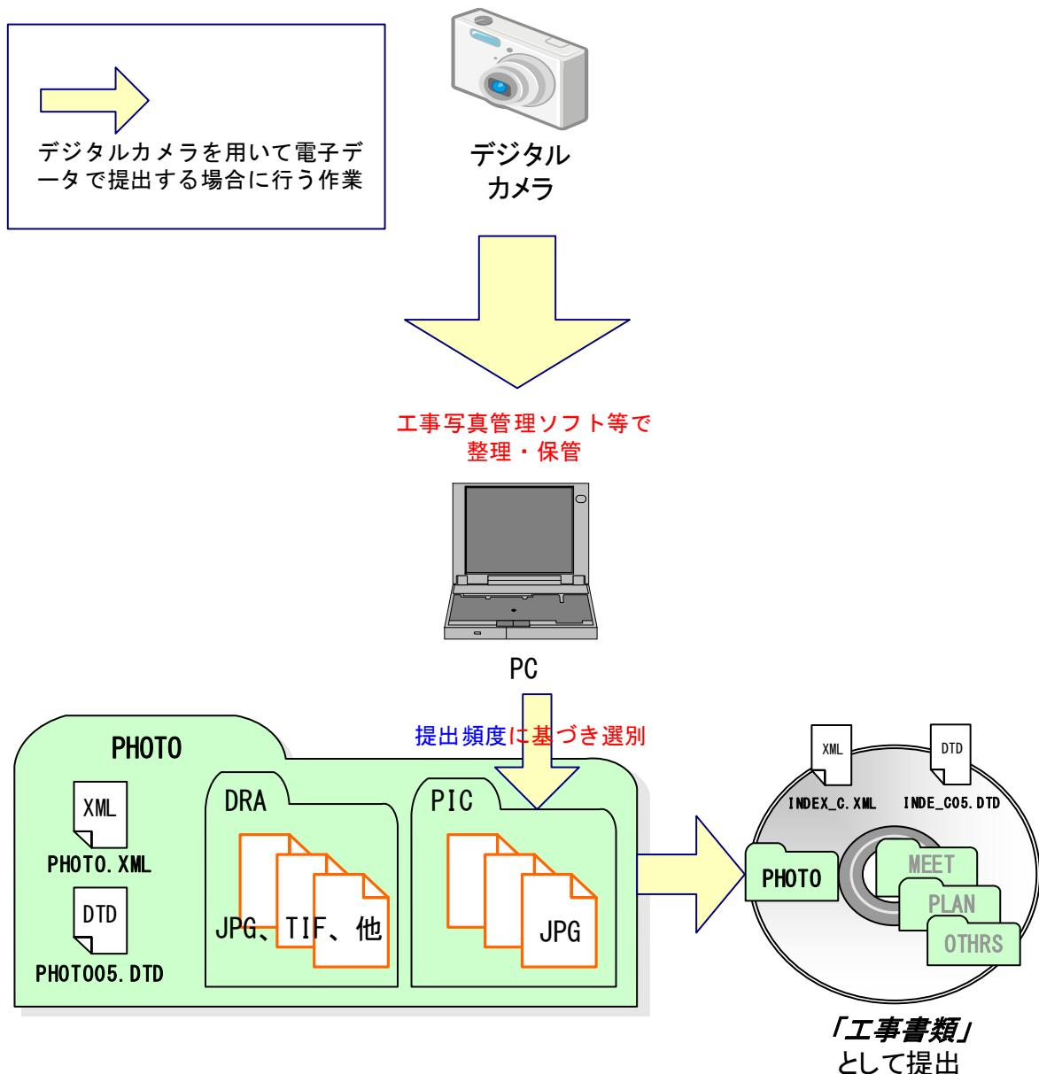
図 9-1 工事写真の納品および提出方法
