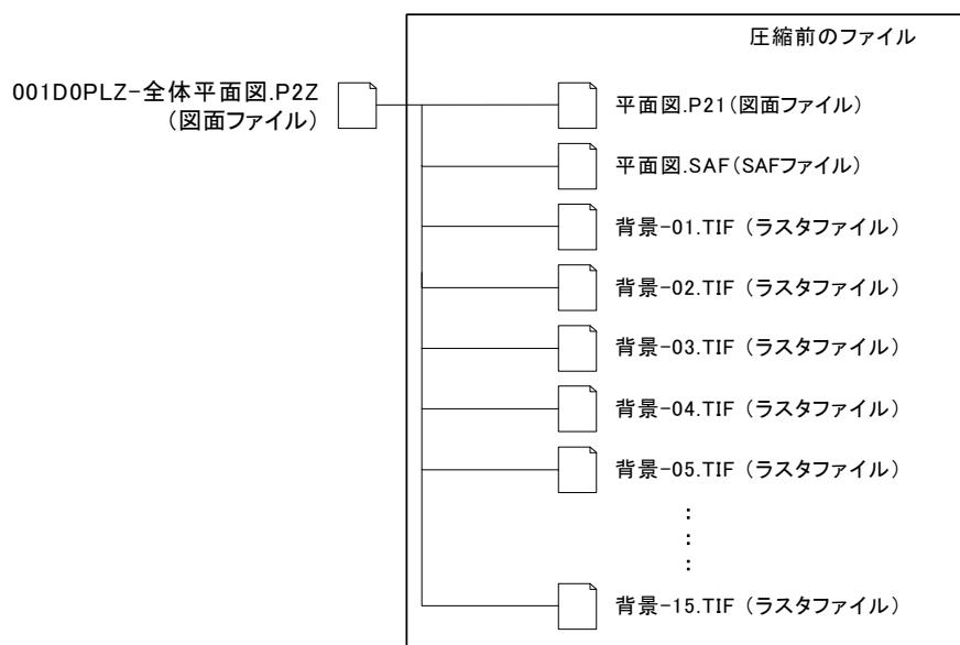
図 2-10 SXF(P2Z)形式のデータ構成例
