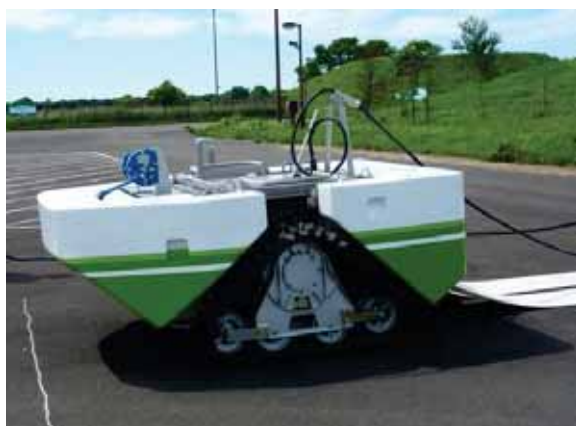
排水ポンプ設置支援装置（自走型）
