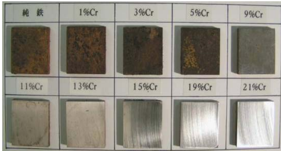
Fe-Cr合金の人工海水中浸漬後の外観 (25°C、人工海水中、3ヶ月間)
