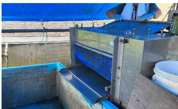
コンブ洗浄機。これに 1 枚ずつコンブを入れて洗浄します。
