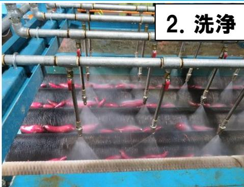
浸漬した後、傷防止のため水圧洗浄で汚れを落とします。
