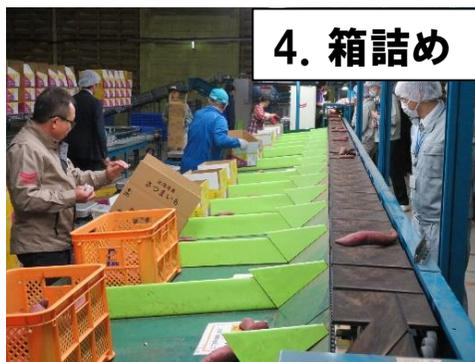
階級は機械(重量計測器)によって自動的に振り分けられ、梱包されます。
