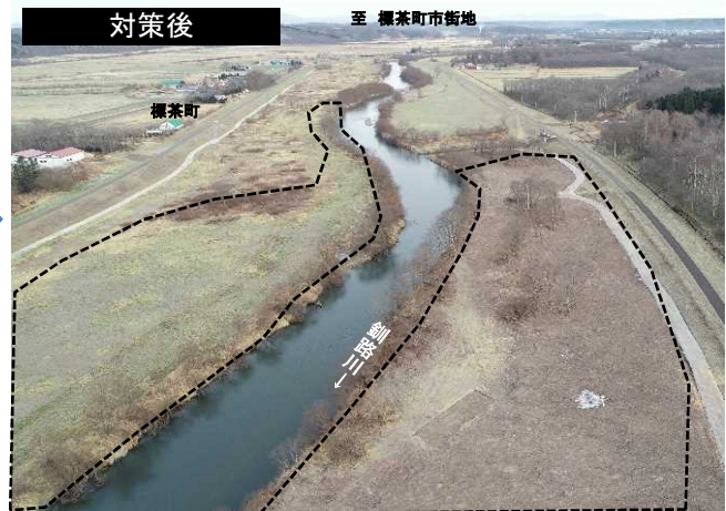
河道掘削・樹木伐採状況
