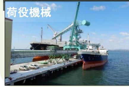
本船から荷役機械を経由して、リアルタイムに内航船へ直接投入している状況
