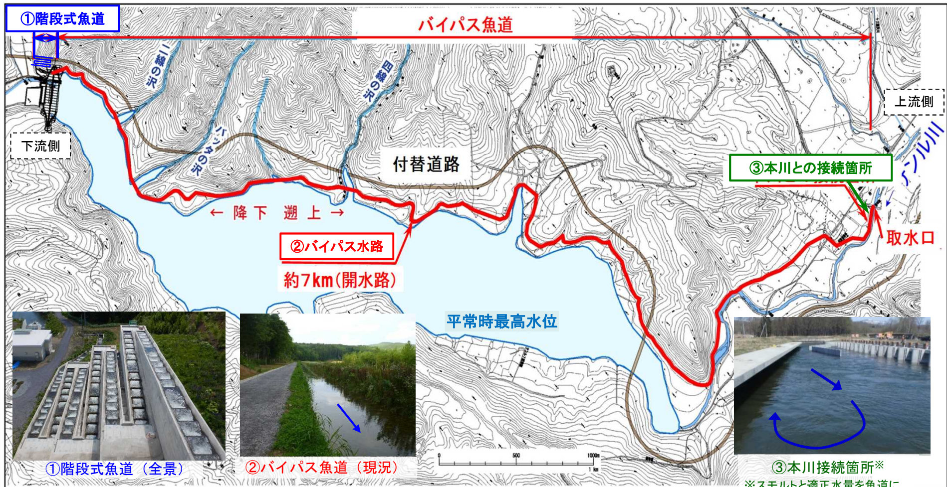
図 2 - 1 8 サンルダム魚道全体平面図
