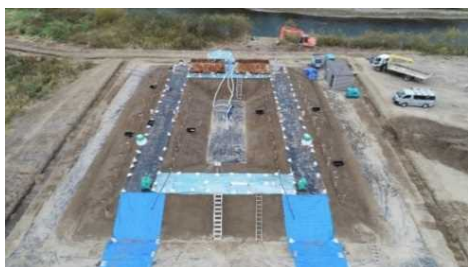
写真2-5 現地堤防実験の様子（降雨による川裏法尻の変状）
