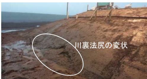
写真2-5 現地堤防実験の様子（降雨による川裏法尻の変状）
