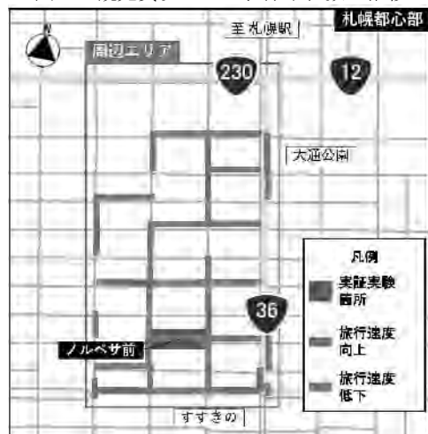
図-3 ETC2.0 プローブデータを用いた旅行速度分析結果
