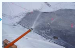
▲地下水を散水し、自然冷気により製氷
