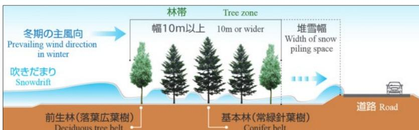
図-2 標準的な防雪林における堆雪状況横断面図<sup>5)</sup>
