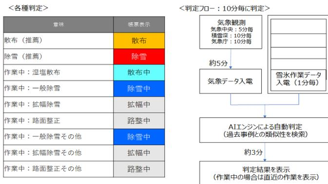
図7. 当システムによる各種判定と作業判定フロー
