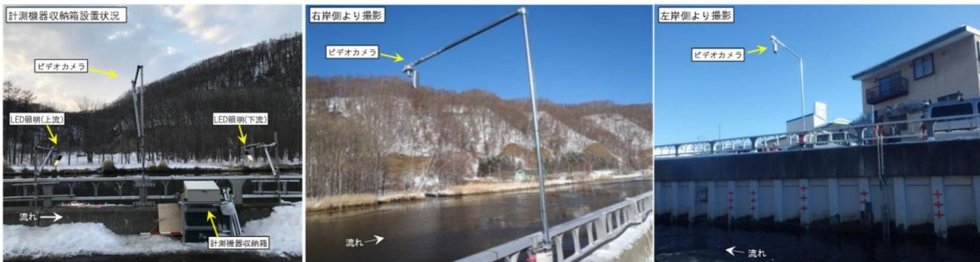
写真-2 ビデオカメラの設置状況
