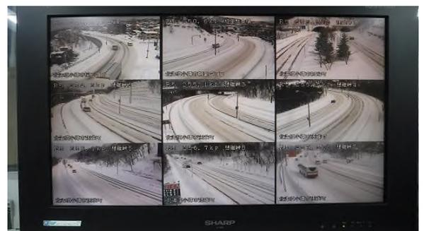
写真-5 CCTVカメラによる峠の集中監視
