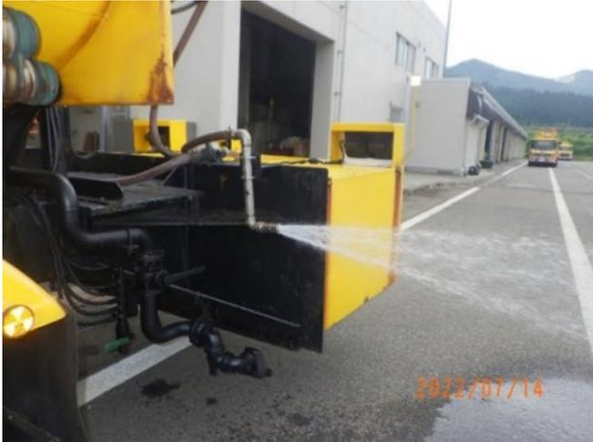
写真-4 散水車改良（ノズル取付）
