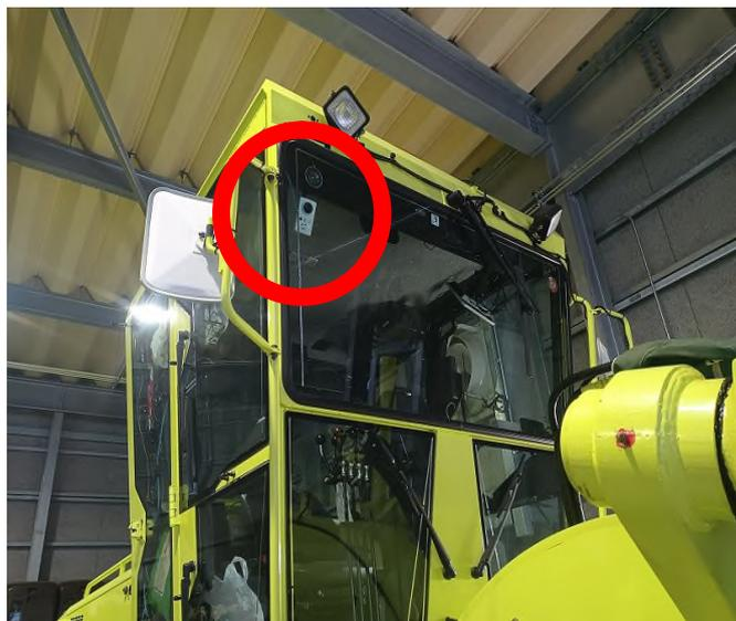
写真 3 カメラ設置位置（丸で囲った箇所）
