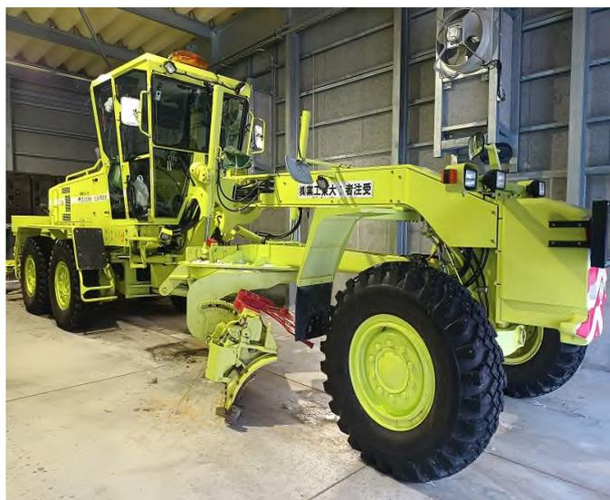
写真 2 カメラを搭載したワンマン型除雪グレーダ
