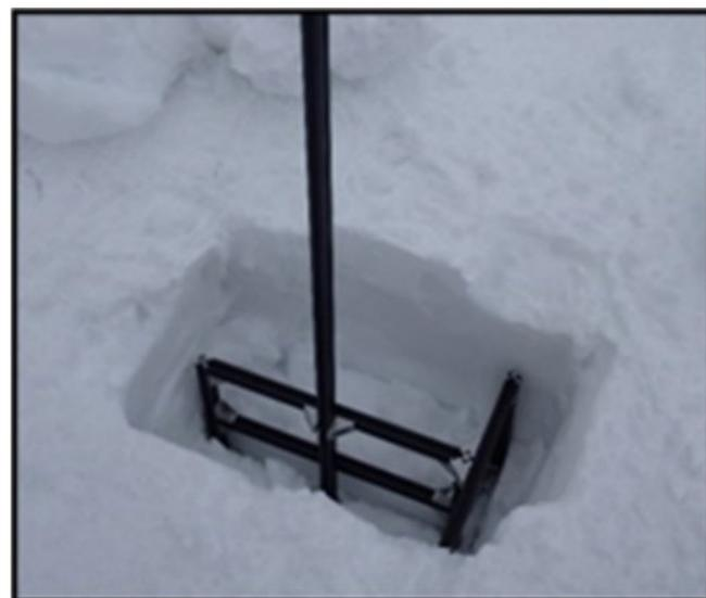
写真-9 ロープ固定用アンカー（埋設式）
