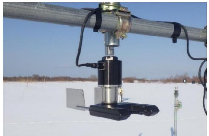
図2 吹雪粒子計(株)新潟電機製SPC-95)。
