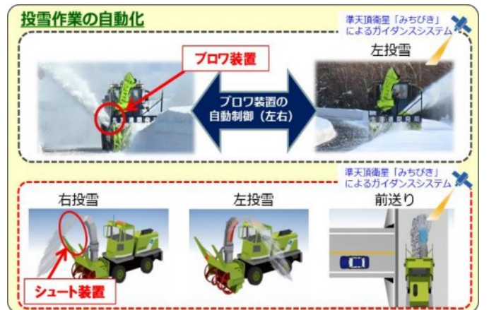
(図-4 ロータリ除雪車投雪作業の自動化)
