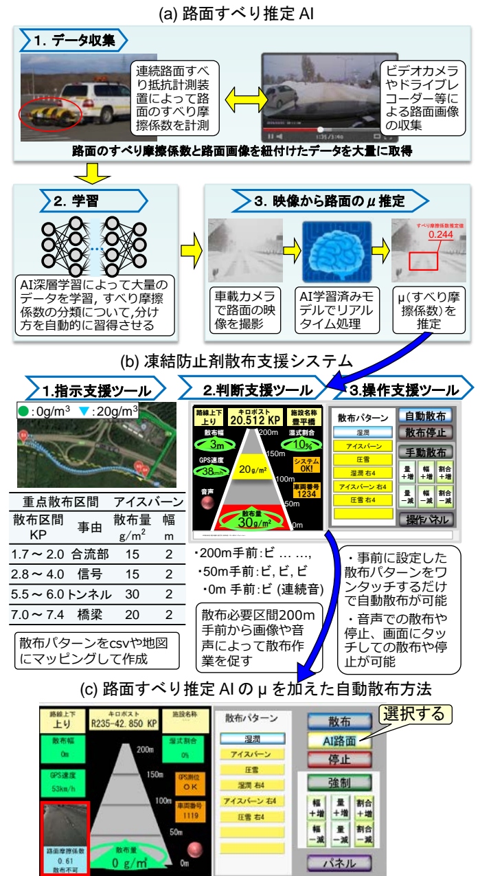
図2 路面すべり推定AIの \mu を散布判断に加えた凍結防止剤散布支援システムの散布フロー
