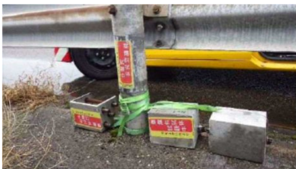
図4 暴露試験供試体設置状況
