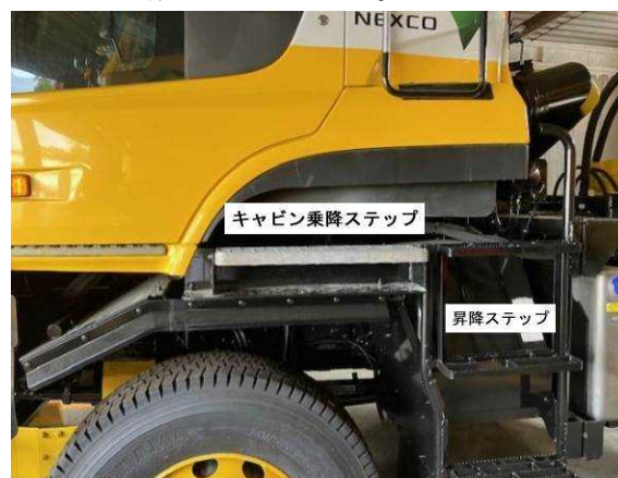
図-6 昇降設備の構造
