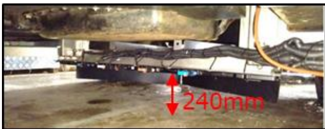
(図-12 車両側のアンテナ設置状況)
