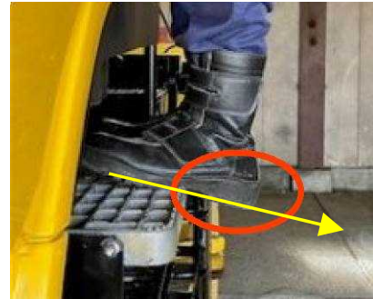
図-10 踵のはみ出し状況
