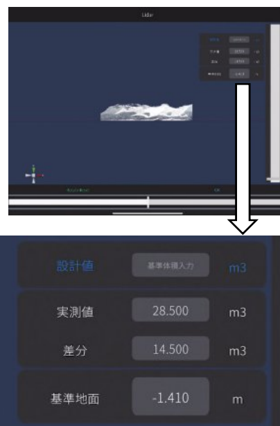
図3 3次元解析による数量算出結果
