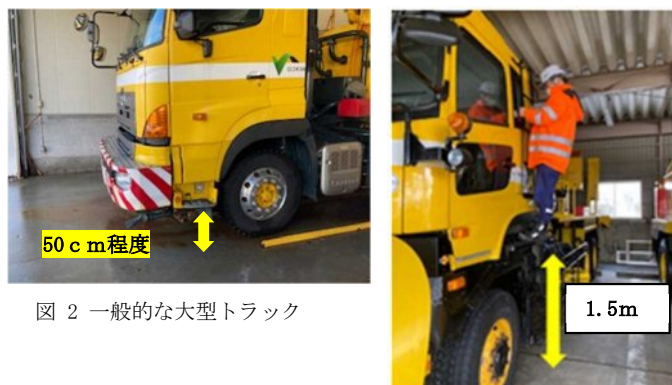
図-3 除雪トラックのステップ高さ
