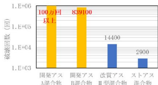
図3 曲げ疲労試験結果 (破壊回数)
