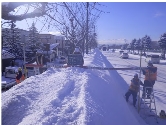
写真1 堆雪量確認（人力検尺）状況（従前）
