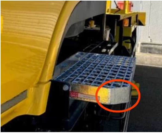
図-18 角部斜め加工状況
