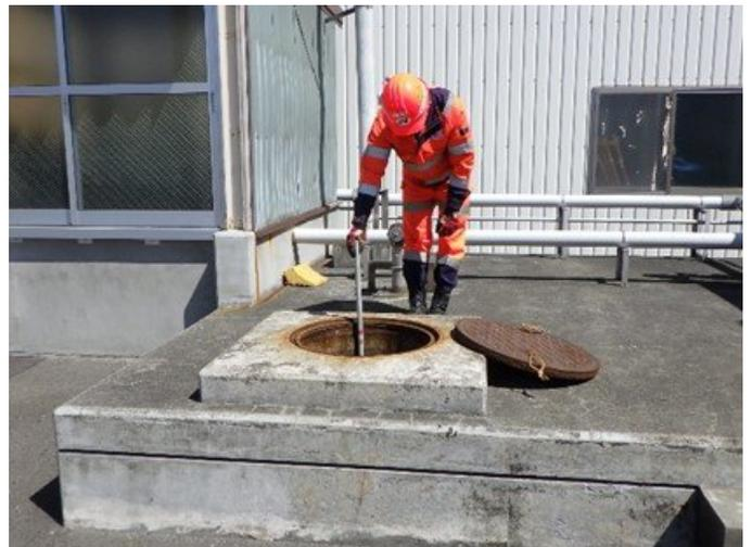
写真-2 薬液量の測定状況①
