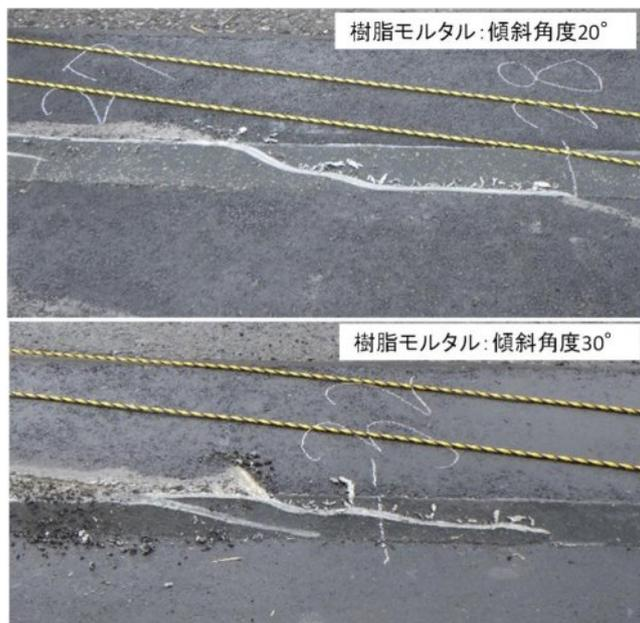
図10 樹脂モルタルの損傷状況
