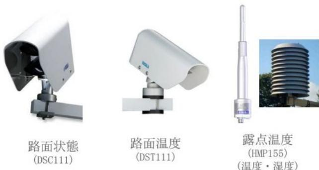
写真2 固定式センサの一例
