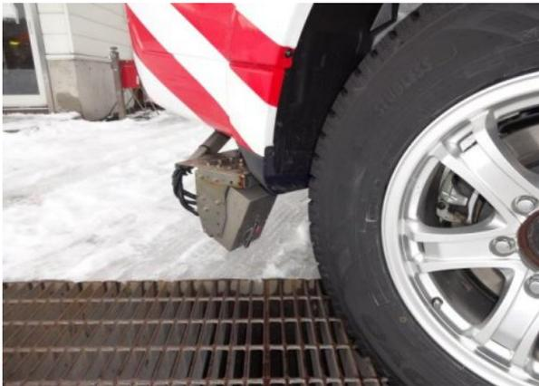
写真2 塩分濃度センサ取付イメージ図
