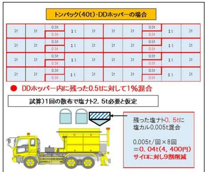
図-3 トンパック及びDDホッパー式の場合
