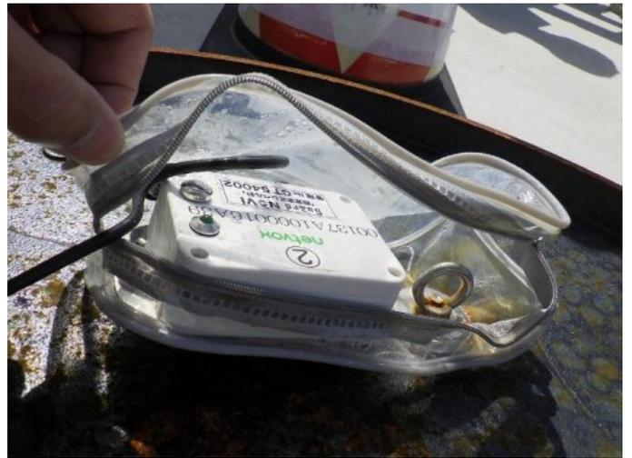
写真-6 薬液量測定装置本体（子機）
