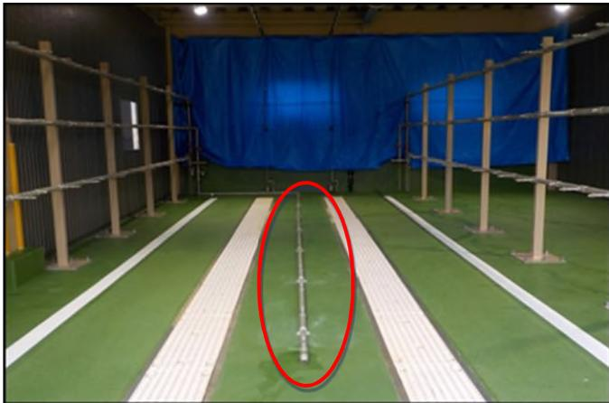
図10 車庫内洗浄装置追加ノズル
