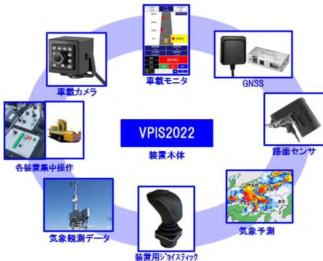
●図1-車両位置情報システム（VPIS）の構成
