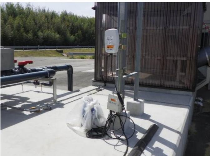
写真-5 薬液量測定装置本体（親機）
