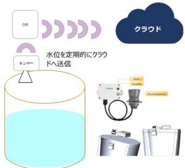
図-3 薬液量測定装置イメージ
