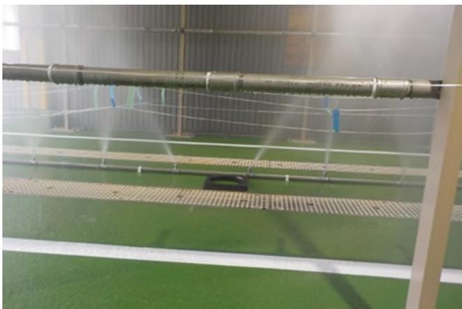
図12 車庫内洗浄装置追加ノズル噴射 側面
