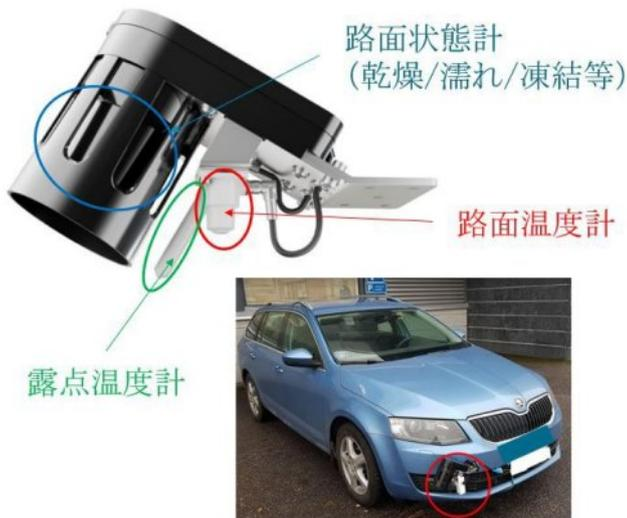
写真1 モバイル式センサの一例
