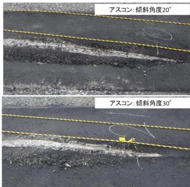
図11 アスコンの損傷状況
