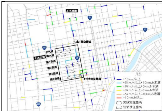
図-10 ETC2.07° ロープデータを用いた旅行速度分析結果 (秋期平日17時台)
